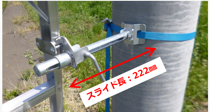
収納状態 取付けたまま脚立を折畳めます
